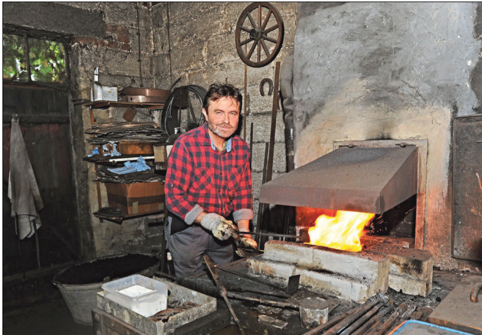
In seinem Schmiedeofen in der Altstädter Angertwete erhitzt Hans-Jürgen Kugland das Rohmaterial aus Stählen unterschiedlicher Härte
