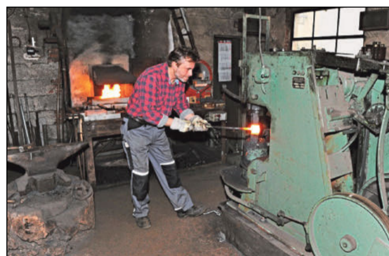
In Handarbeit werden Stähle unterschiedlicher Härte und Legierung unter dem Federhammer geschichtet und geschmiedet.
